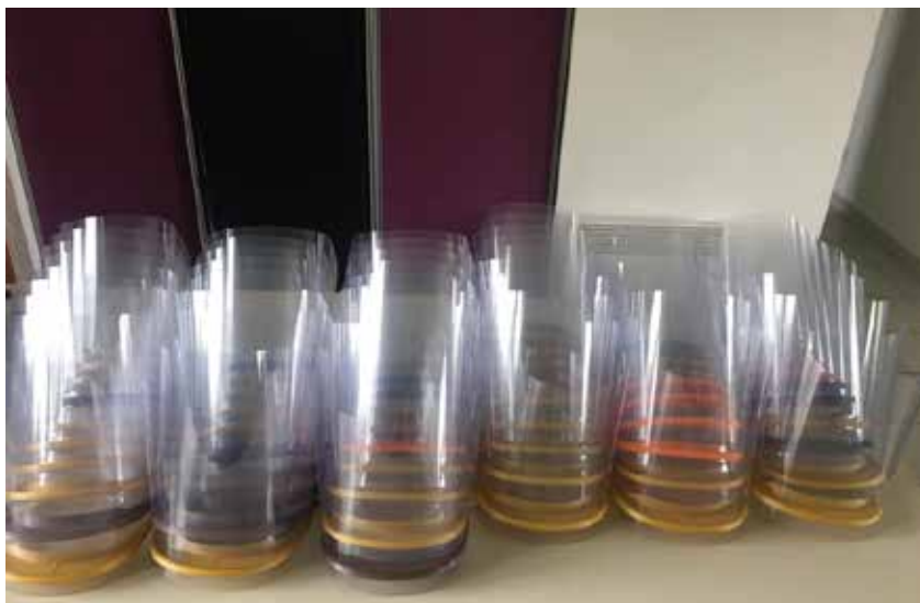
Des visières de protection, réalisées par un groupe de bénévoles avec une feuille de transparent et une armature imprimée en 3d, ont permis à des milliers de personnes sur le terrain d'être mieux protégées.
