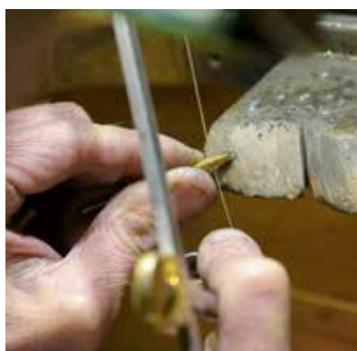
Après avoir chauffé et étiré le lingotin, Pascal coupe la pointe qui permettra d'agrandir la bague
