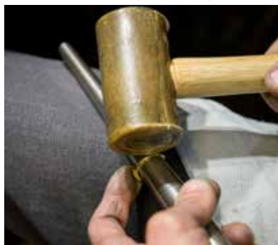
Un petit marteau en cuir permet d'ajuster au plus près la taille de la bague.
