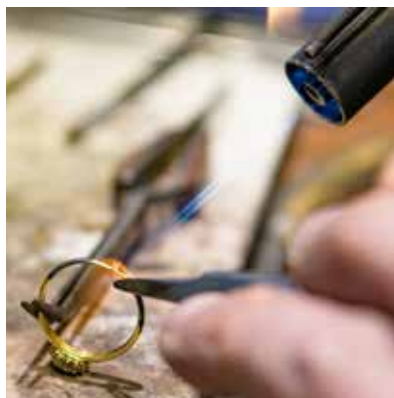
Le morceau d'or est placé sur l'anneau puis chauffé au chalumeau pour agrandir la bague
